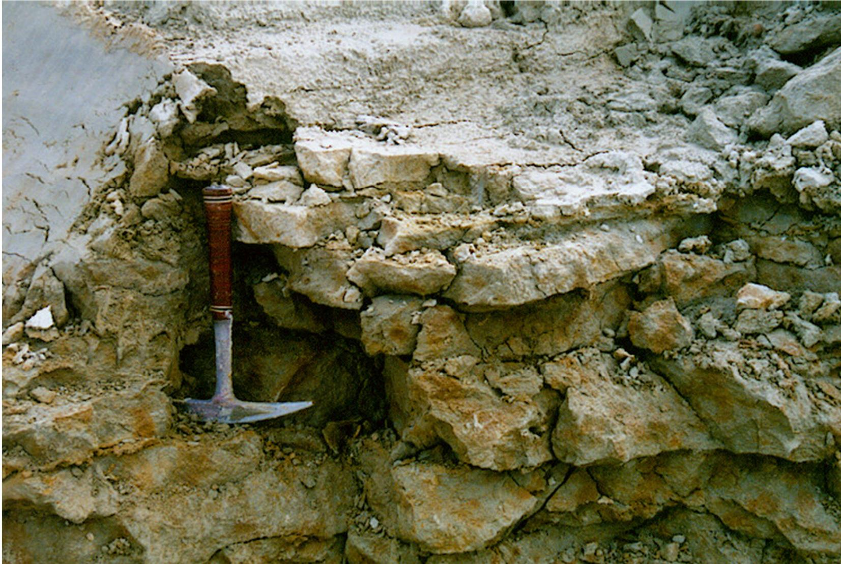
**Klüftung schwach verfestigter tertiärer schluffiger Sande im Einschnitt E 11 der NBS N-I**
