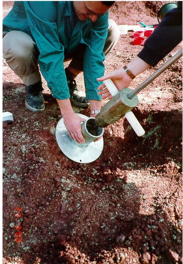
Bild 4: Probenentnahme aus der fossilen Gleitfläche im Bereich der Böschungsrutschung im Voreinschnitt Nord für den Tunnel Göggelsbuch
